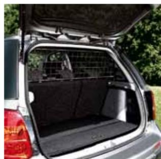
**4.1** Защитная сетка грузового отсека.
