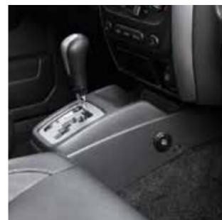
**3.13 Замок АКПП.** Противоугонное устройство бесштыревой конструкции. Отличается простотой в эксплуатации и удобством использования. Блокировка рычага КПП производится в положении Parking.
