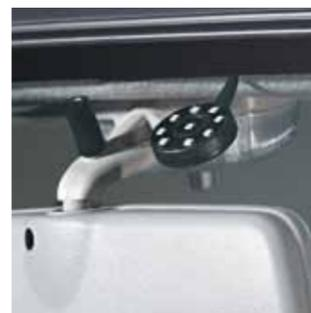
**3.12 Датчик дождя.** Автоматически включает дворники лобового стекла, подбирает оптимальный режим и интервал их работы.
