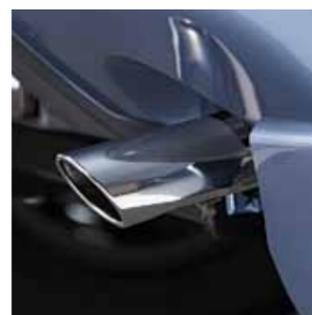
**1.15 Декоративная насадка выхлопной трубы.** Нержавеющая сталь. 00800-60912-K00
