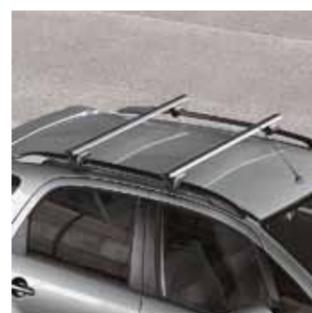
**4.8** Багажник на крышу. Максимально допустимая нагрузка 50 кг.
