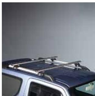
**4.2 Багажник на крышу.** Максимально допустимая нагрузка 30 кг. **990E0-79J14-000**
