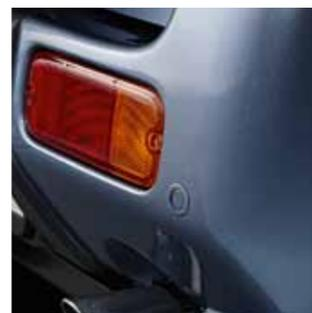
**3.9 Датчики парковки.** Комплект из 4 шт. с пьезоэлементами. Сенсоры могут быть окрашены в цвет кузова.
