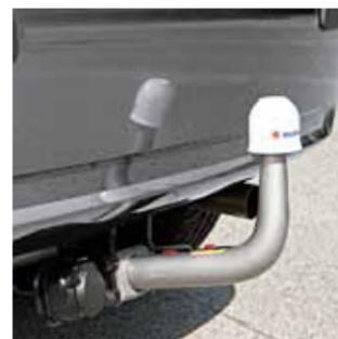
**4.13** Фаркоп. Максимальная масса буксируемого груза 1200 кг. Максимально допустимая вертикальная нагрузка на крюк фаркопа 50 кг. Электрический разъем для подключения фонарей прицепа заказывается отдельно. Дополнительная информация указана в руководстве по эксплуатации Вашего автомобиля. Съёмный.
