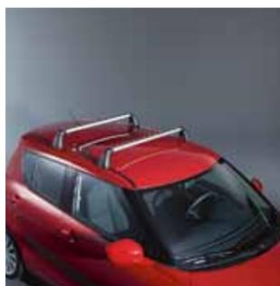
**4.2 Багажник на крышу.** Максимально допустимая нагрузка 50 кг.
