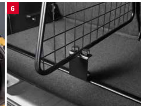
6 | Крепеж для продольной сетки багажного отделения. 990E0-54P48-002
