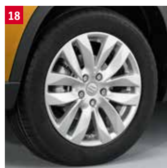
16 | Легкосплавный диск «Spider» 6,5 J x 16". Ярко-серебристый с эффектом затемнения боковых частей диска на солнце. 990NW-54P6S-SDR 990NW-54P6S-DST
