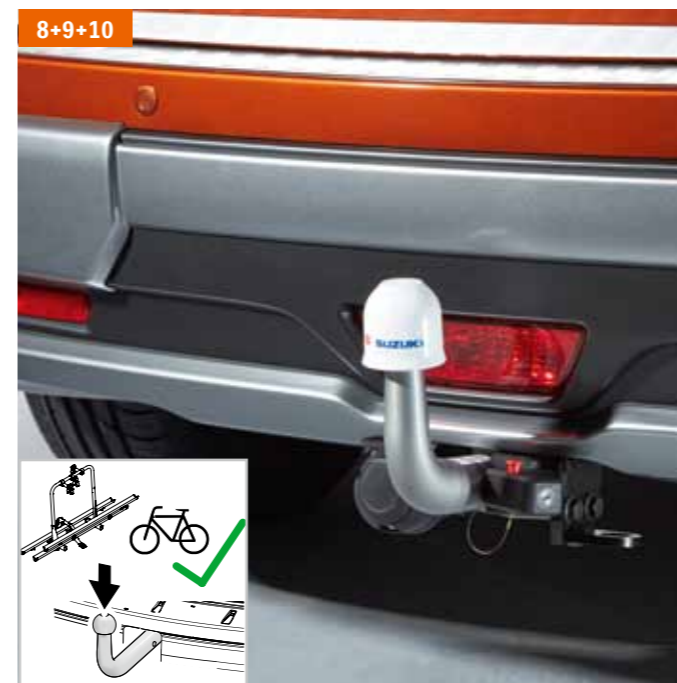
8 | Демонтируемый фаркоп. 6 Макс. допустимая вертикальная нагрузка на крюк фаркопа 75 кг. Электрический разъем для подключения фонарей прицепа заказывается отдельно. 72901-54P00-000
